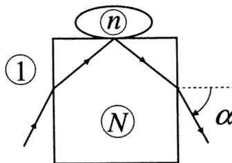
1. En utilisant la loi de Descartes sur la réfraction, déterminer l'angle  $\alpha_i$  entre le rayon sortant avant sa sortie du réfractomètre, et la normale au dioptre, en fonction de  $\alpha$  et de  $N$ .
