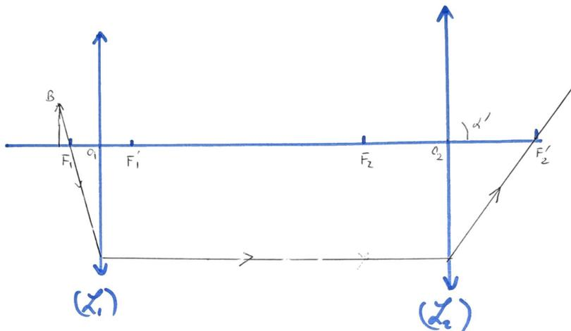
4. Sur le schéma précédent on voit que  $\tan \alpha' = -\frac{\overline{A'B'}}{f_2'}$ . On a par ailleurs, d'après la définition de l'énoncé :  $\tan \alpha = -\frac{\overline{AB}}{2f_1' + \Delta + 2f_2'}$  (angles comptés positivement dans le sens trigo). Dans les conditions de Gauss, les angles sont tels que l'on peut écrire :  $\tan \alpha \sim \alpha$ , d'où :
