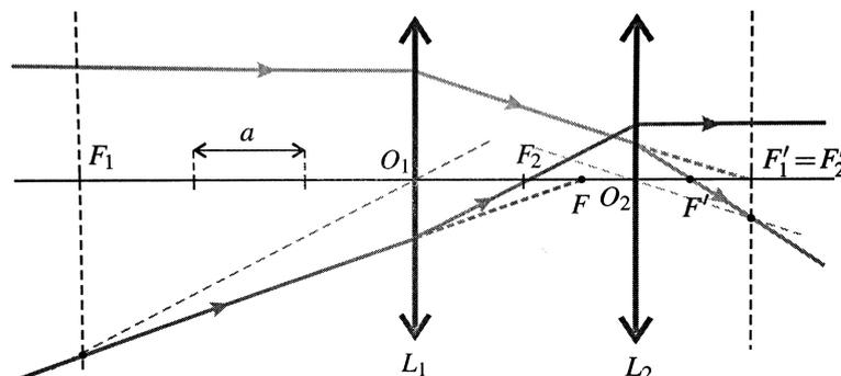
2. Le point à l'infini a pour image  $F'_1$  par  $L_1$  qui a pour image  $F'$  par  $L_2$ , ce que l'on peut résumer par le schéma :  $\infty \xrightarrow{L_1} F'_1 \xrightarrow{L_2} F'$ . D'après la relation de conjugaison de Newton :  $\overline{F'_1 F'} = -\frac{(f'_2)^2}{F'_1 F_2} = -\frac{a^2}{2a} = -\frac{a}{2}$ .
