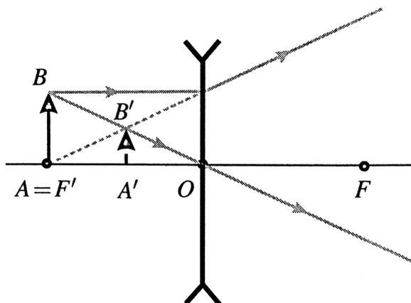
2. Pour répondre à cette question il faut calculer le grandissement entre les plans de front conjugués passant par  $A$  et  $A'$ . En utilisant la relation de Thalès dans le triangle  $OAB$  on a :  $\gamma = \frac{A'B'}{AB} = \frac{OA'}{OA} = \frac{1}{2}$ . D'où  $\overline{A'B'} = 0,5 \text{ mm}$ .
