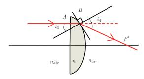
Le rayon incident arrive perpendiculairement à la surface de la lentille, il n'est donc pas dévié. Ensuite, arrivé sur le second dioptre, il est réfracté en s'éloignant de la normale, puisque le rayon passe d'un milieu plus réfringent à un milieu moins réfringent.
